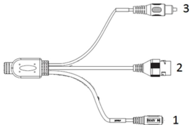
1. Разъем питания предназначен для подключения питания 12В.
