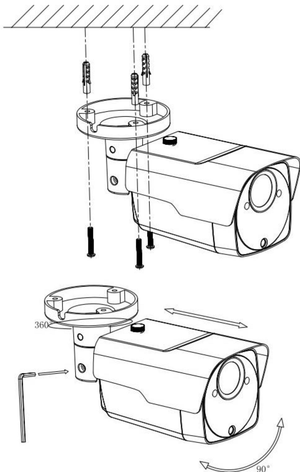
Монтаж камеры может осуществляться как на горизонтальную поверхность, так и на вертикальную. После монтажа на поверхность, настройте ракурс обзора камеры.
